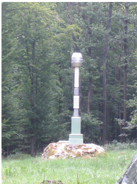
Obr. č. 5.1 Anténa kapacitného typu (tzv. „ball antenna“) pre príjem vertikálnej elektrickej zložky poľa SchR používaná na AGO FMFI UK Modra – Piesok.
